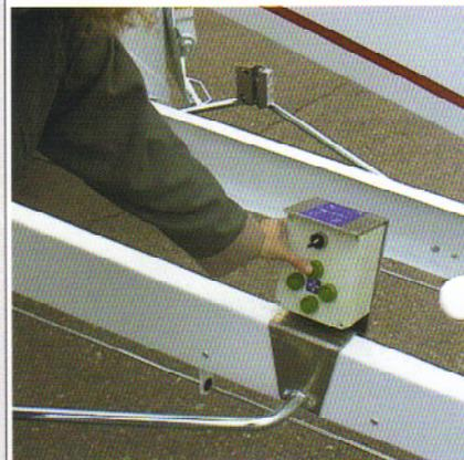
Seitlich an der Zugdeichsel befindet sich das Bedienpult für die Betätigung des hydraulischen Fahrtriebes zum leichten Bewegen der Maschine.
