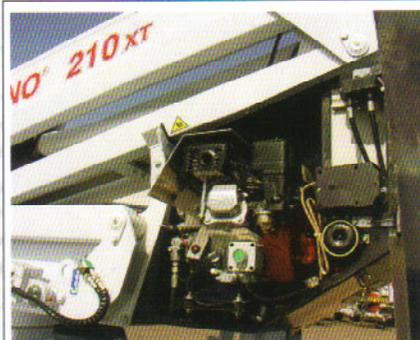
Mittels dem Benzinaggregat kann die Bühne verwendet werden auch wenn Elektrizität nicht vorhanden ist.
