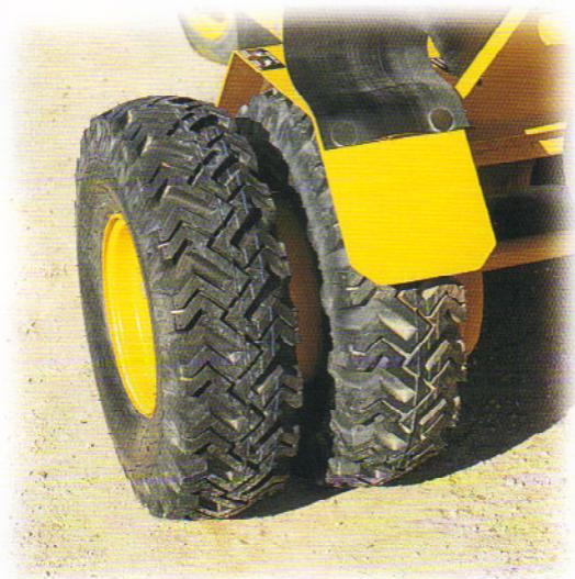
**Die optionale Doppelbereifung** verbessert die Tragfähigkeit auf weichen Böden und ermöglicht Arbeiten bei eingeschränkten Bodenverhältnissen.
