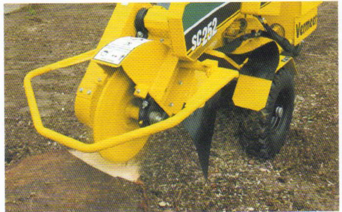
**Die Schneidradbremse** ist in die Kupplung integriert und tritt bei Abschaltung des Fräsrades automatisch in Kraft. Dadurch kommt das Schneidrad innerhalb weniger Sekunden zum Stillstand.
